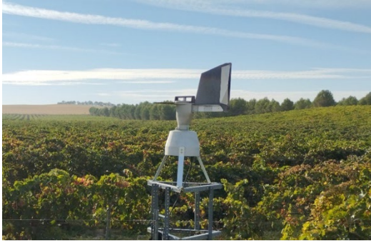
Captador volumétrico tipo Hirst , utilizado para la captación del polen y las esporas presentes en el aire.
